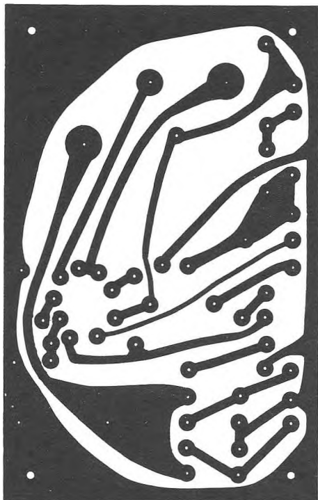
Fig. 89. Printtegning til spændingsforsyning med IC
